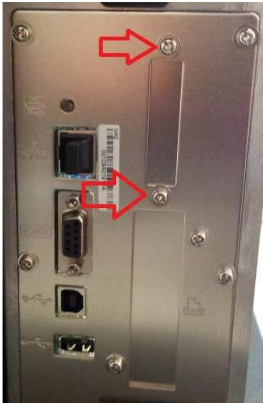
**PASO 4:** Instalar el puerto aplicador y sujetarlo con los dos tornillos.
